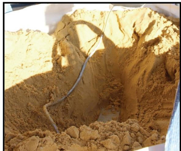
Abbildung 31 - Beschleunigungsaufnehmer a-5-8 (Schüttgut 2)
