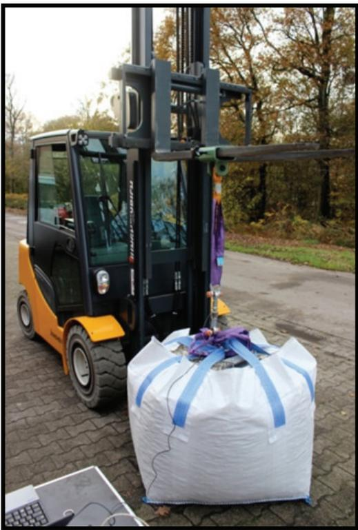
Abbildung 15 - Messung der Gewichtskraft
