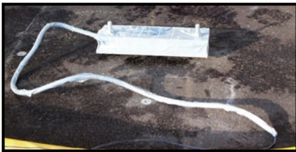
Abbildung 30 - Beschleunigungsaufnehmer a-5-8 (Schüttgut 1)
