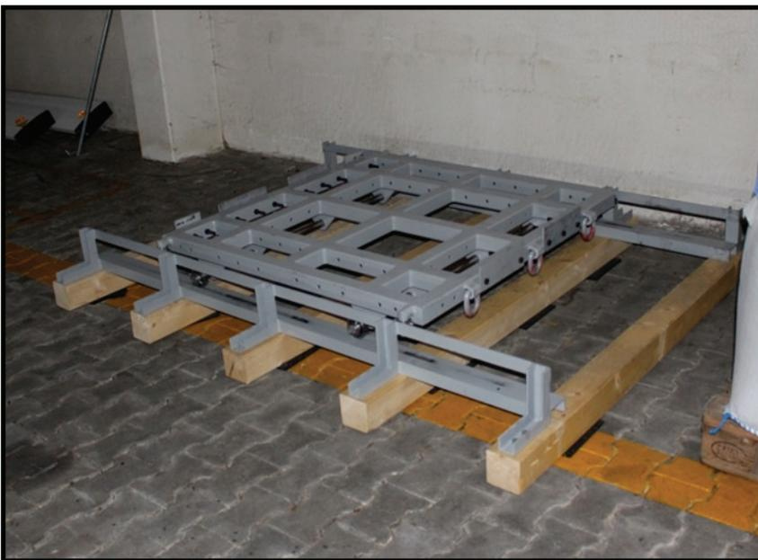
Abbildung 1 - Rollwagen und Laufschiene
