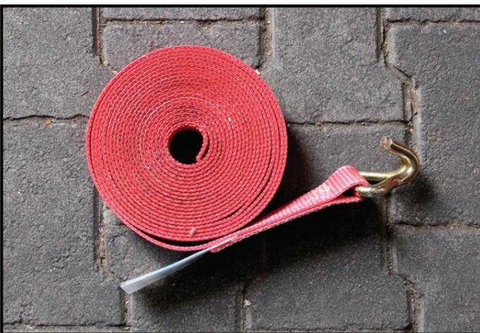
Abbildung 5 - Spannelement 1 Losende
